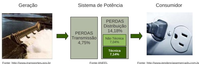
Figura 4: Perdas Técnicas e Perdas Não Técnicas na Distribuição
