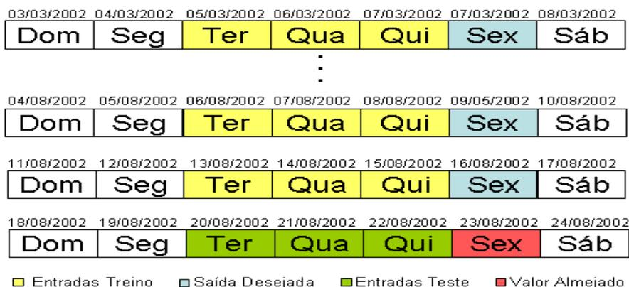
Fig. 3. Esquema organização dos dados para treinamento das componentes de previsão.
