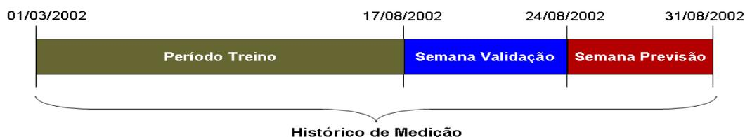
Fig. 4. Exemplo de um esquema de divisão do histórico de consumo de carga.
