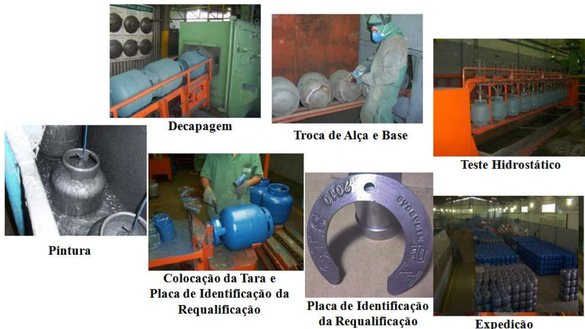
Figura 1. Processo de requalificação de botijões P13. Fonte: ANP(2010)
