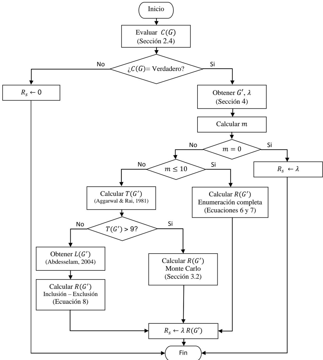
Figura 4. Algoritmo para evaluar la confiabilidad global de redes generales no dirigidas
