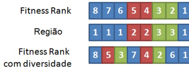
**Figura 1. Esquema do funcionamento do ranking com diversidade**
