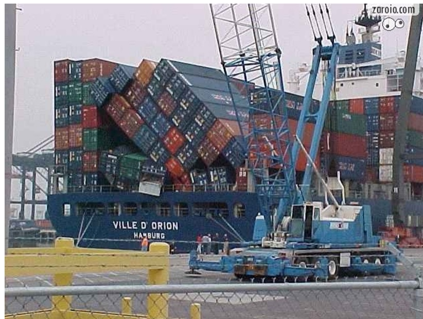
Figura 17: Acidente no carregamento de contêineres em um navio. Fonte: TCLN (2014).
