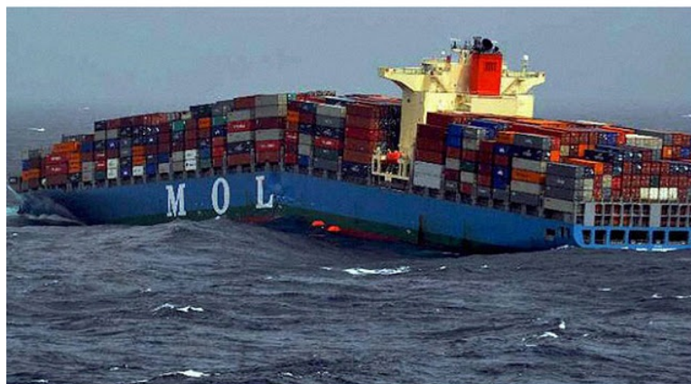
Figura 18: Acidente no transporte de contêineres com danos na estrutura do navio. Fonte: RNZN (2014).
