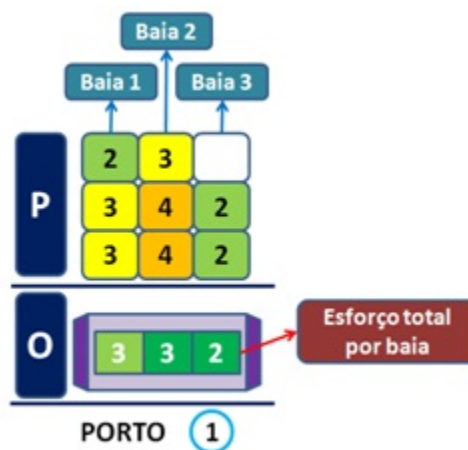
Figura 34: Acoplando o plano de estiva (P) com a operação de guindastes (O).
