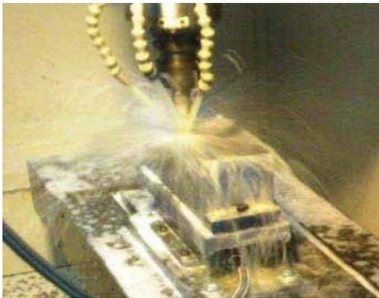
Figura 1 - Fresamento de topo do aço ABNT 1045
