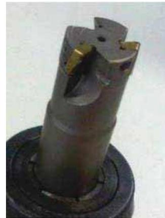
Figura 2 - Ferramenta de corte (fresa de topo)
