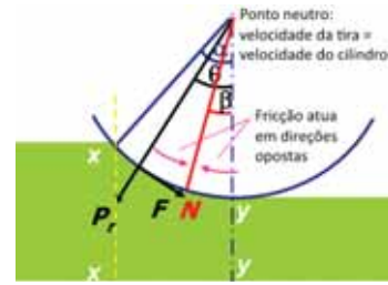
Figura 3: Ponto neutro ou de fricção nula. Fonte Udomphol (2007)
