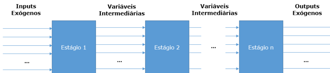
Figura 2: Sistema serial com n estágios ([Kao e Hwang, 2008])
